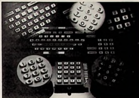
Bild 6: Einige Tastenfelder mit magnetischer Tastenrückholung (RTC)
