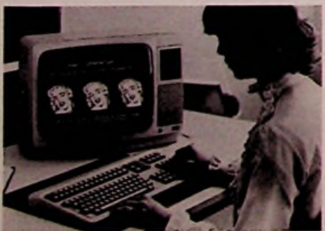
Bild 1: Terminal BBT 02 mit Tastatur für den neuen Btx-Standard (Foto: Loewe)
